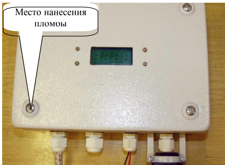
Рисунок 3 - Схема пломбирования газоанализатора ИКТС-11 исполнения ИКТС-11.М от несанкционированного доступа.
